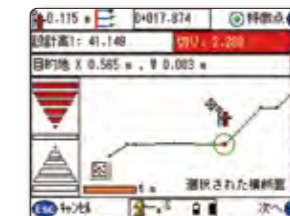
▲道路の丁張り・杭打ち
